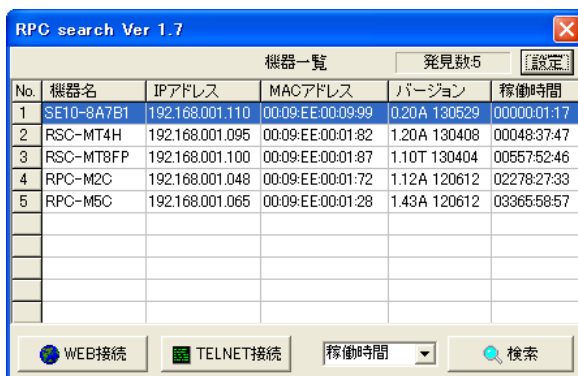
RPCサーチソフト機器検索画面
