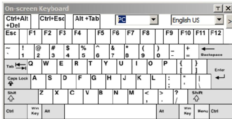
オンスクリーンキーボードの主な利点の 1 つは、リモートシステムとローカルシステムのキーボード言語が同じでない場合、どちらのシステムの構成設定も変更する必要がないことです。ユーザーは画面上のキーボードを呼び出すだけで、アクセスしているポートでコンピューターが使用している言語を選択し、画面上のキーボードを使用して通信することができます。
